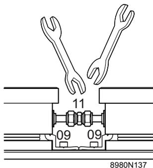
**i** Das vertikale Spiel des Übergangsblechs ermöglicht den Zugang zu den Hydraulikanschlüssen und das Anbringen der Sonnenkollektoren.
