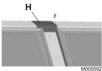
13. Verbindungsblech mit einer Blechschraube am oberen Abdeckteil fixieren.
