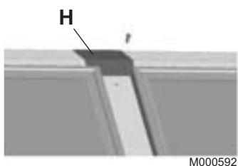
13. Fixer la tôle de jonction à la pièce de recouvrement supérieur à l'aide d'une vis à tôle.
