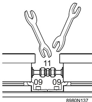
**i** Door de verticale speling van de aansluitplaat heeft men toegang tot de hydraulische aansluitingen en kunnen de zonnecollectoren bevestigd worden.
