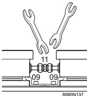
**i** Le jeu vertical de la tôle de jonction permet d'accéder aux raccords hydrauliques et de fixer les capteurs solaires.
